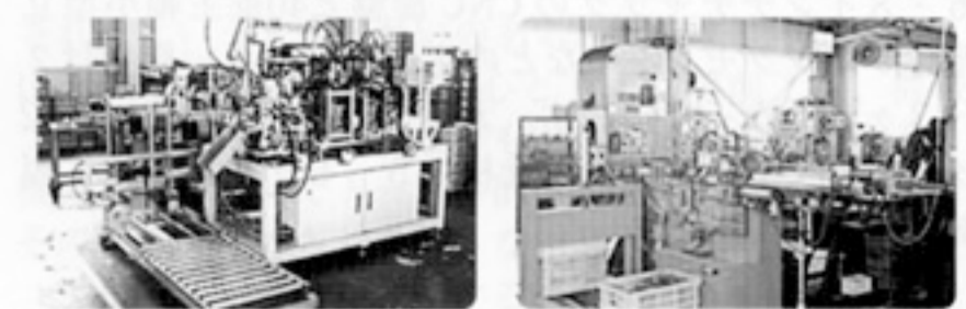
整然と並ぶ自社製自動機 左：板バンド自動加工機、右：縦型ワイヤーバンド自動加工機
