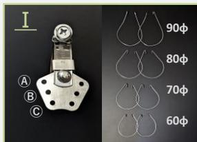
I 結束する竹の直径を測り、使用するリングのサイズを選定、引っかける位置を決めます。別紙組み合わせ表参照
